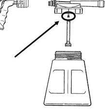
Wasser-Betriebsdruck: ab 1,5 bar bis maximal 6 bar
